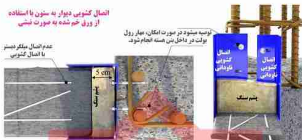
عکسهای روند محاسباتی ارائه شده در شکل ۲۴، برای اتصال به صورت جدول نبشی نیز هر متر از طول اتصال نودانی با ۳ عدد ورق بولت ۸ میل به ستون متصل می‌شود.
