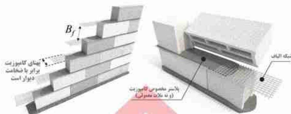
شکل ۳-۳: کمیت‌های مورد نیاز برای محاسبه ظرفیت خمشی افقی دیوارهای بنایی مسلح به کامپوزیت شبکه الیاف در بند بستر.
