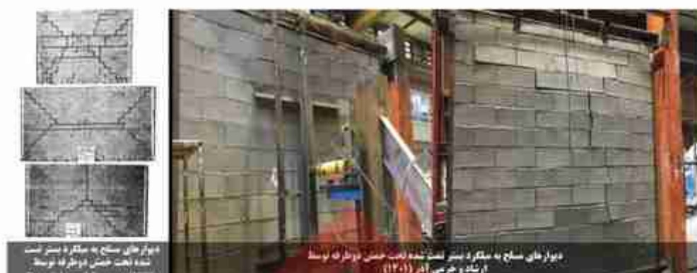
شکل پ-۲-۸ آزمایش‌های انتخابی به منظور بررسی دقت رابطه تخمین ظرفیت خارج از صفحه دیوارهای مسلح به میلگرد یستر تحت خمش دوطرفه.
