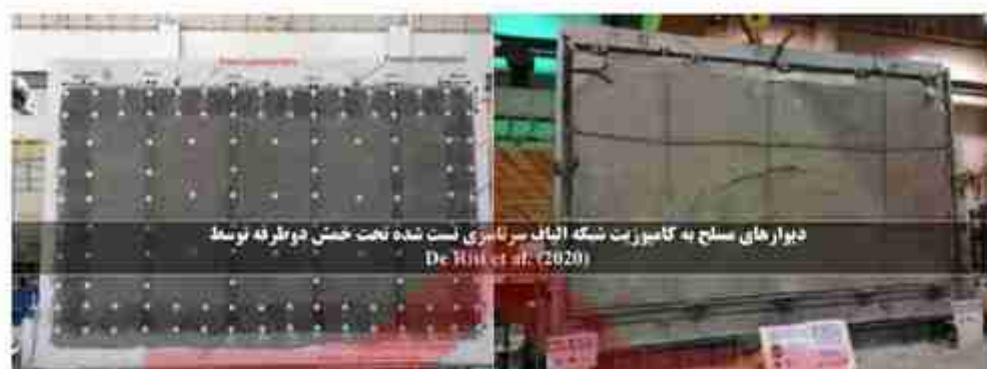
شکل پ-۹-۲ آزمایش‌های انتخابی جهت بررسی دقت رابطه تخمین ظرفیت خارج از صفحه دیوارهای مسلح به شبکه الیاف سرامیکی تحت خمش دو طرفه.
