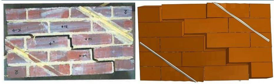
شکل ۱۰-۲. صحت سنجی مدل آباکوس دیوار در خمش مورب (الف) چیدمان تست Willis (2004). (ب) مقایسه منحنی نیرو-تغییر مکان اندازه گیری شده در تست و شبیه سازی شده در آباکوس. (پ). الگوی ترکهای مشاهده شده در تست و مدل آباکوس
